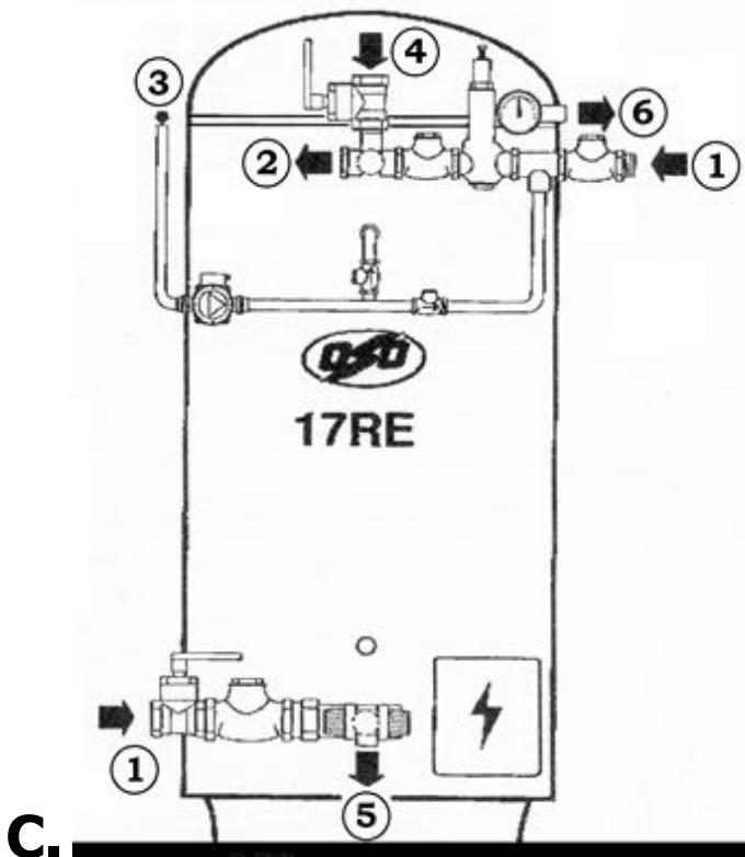
**Схема подключения с термосмесительным клапаном**
