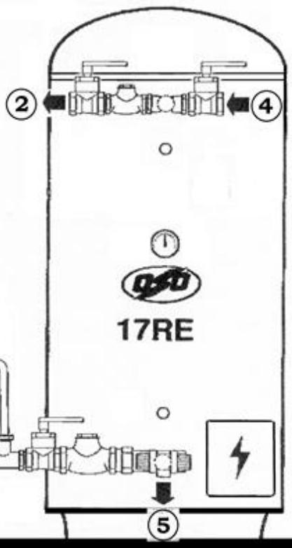
**Схема подключения с циркуляцией горячей воды**
