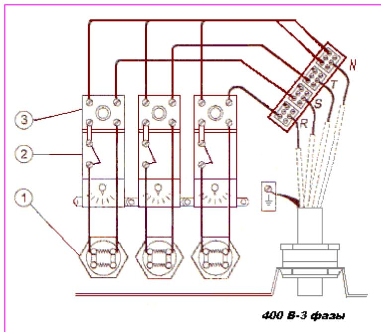
**1 – Нагревательный элемент ( ТЭН ) 3,5,6,10 кВт**
